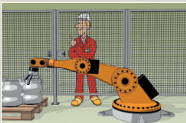
Abb. 4: So ist es besser: Der hohe Zaun ermöglicht kein Übergreifen, die innenliegende Fluchentriegelung ist nur innerhalb der Schutzeinrichtung erreichbar
