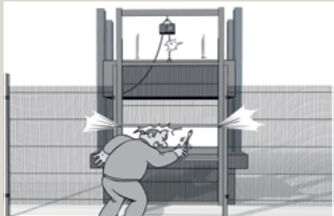
Abb. 2: Herabfallendes Kraftbetätigtes Tor im Maschinen- und Anlagenbau
