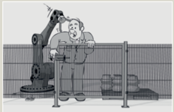
Abb. 3: So soll es nicht sein: Der Maschinenbediener kann die Maschine starten, obwohl er sich noch im Gefahrenbereich befindet
