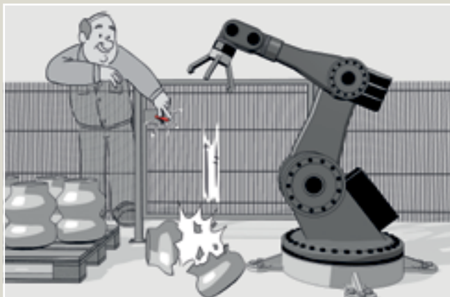
Abb. 2: So soll es nicht sein: Der Maschinenbediener kann eine innenliegende Fluchtentriegelung von außen bedienen
