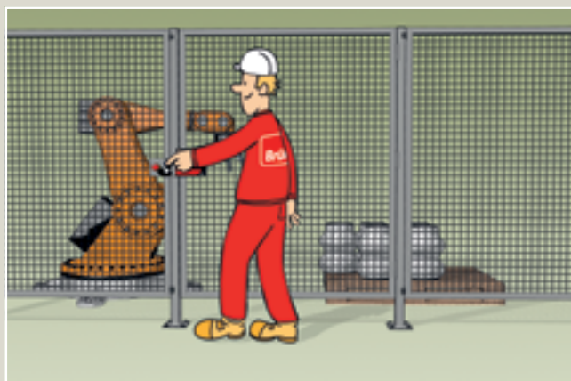
Abb. 5: So ist es besser: Ein höherer Zaun ermöglicht kein Übergreifen, der Maschinenbediener betätigt nur die auf seiner Zaunseite vorgesehenen Bedienelemente
