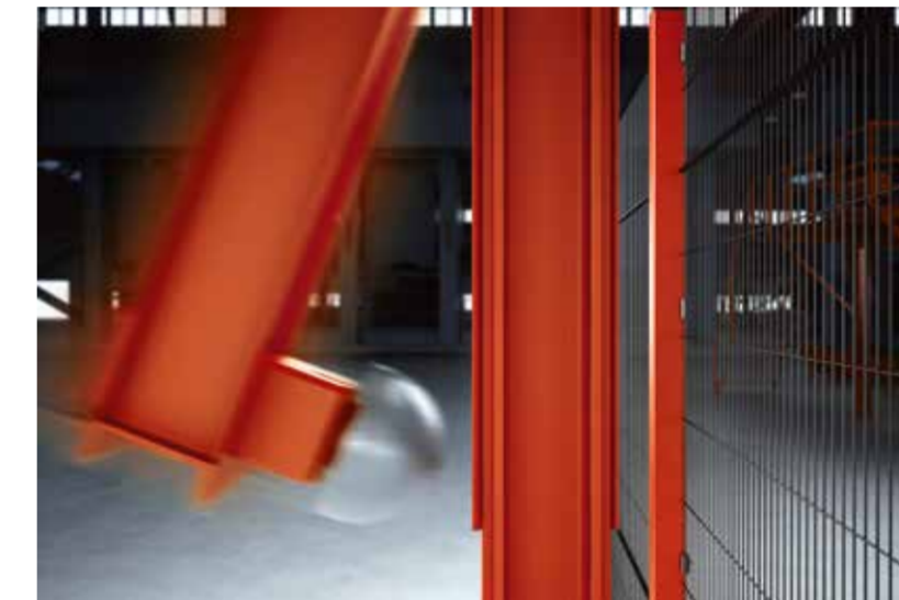
H Höhe der trennenden Schutzeinrichtung h Fallhöhe a Höhe des Aufprallpunktes, welcher nicht über 1600 mm liegen darf Aufbau einer Crashtest-Prüfeinrichtung nach ► EN ISO 14120
