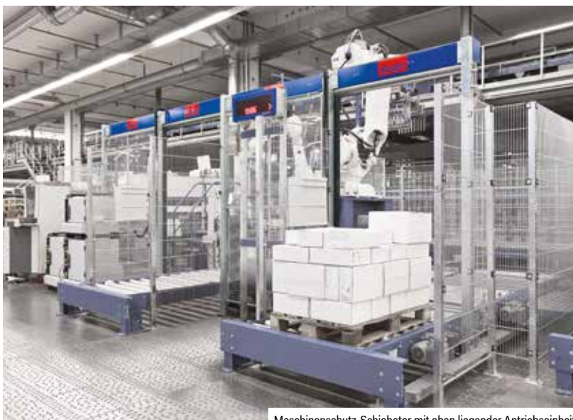
Maschinenschutz-Schiebetor mit oben liegender Antriebseinheit
