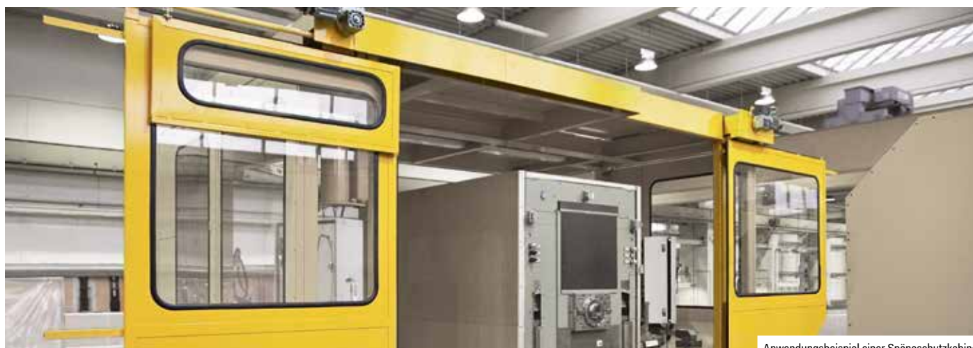
Anwendungsbeispiel einer Späneschutzkabine
