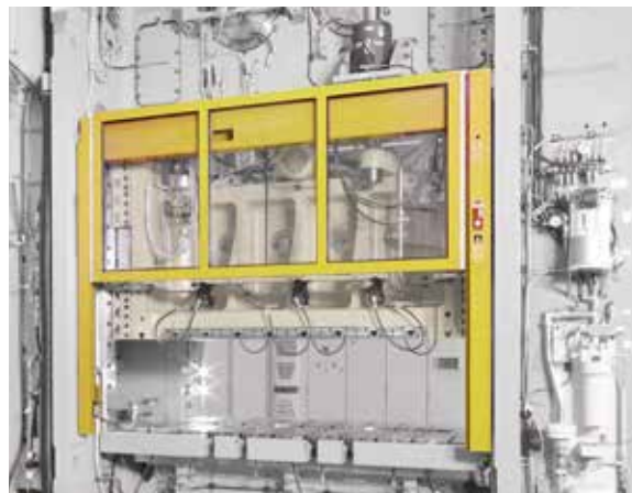
Kompaktes Maschinenschutztor als Prozessintegration mit geringer Einbauhöhe
