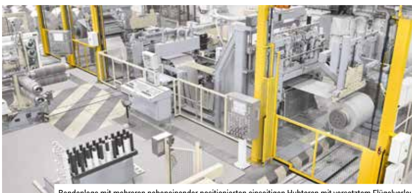
Bandanlage mit mehreren nebeneinander positionierten einseitigen Hubtoren mit versetztem Flügelverlauf
