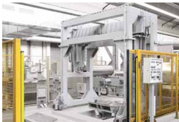
Freitragendes Maschinenschutz-Schiebetor im automatisierten Anwendungsfall
