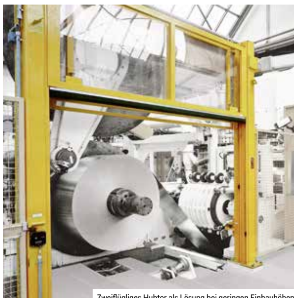
Zweiflügliges Hubtor als Lösung bei geringen Einbauhöhen
