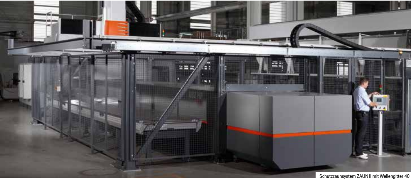
Schutzzaunsystem ZAUN II mit Wellengitter 40
