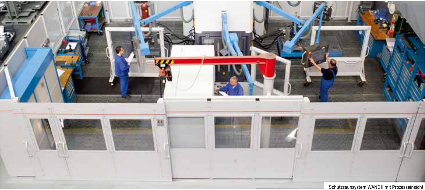
Schutzzaunsystem WAND II mit Prozesseinsicht
