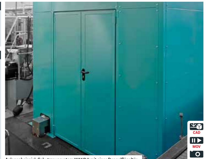
Anlagenbeispiel: Schutzzaunsystem WAND II mit einer Doppelflügeltür
