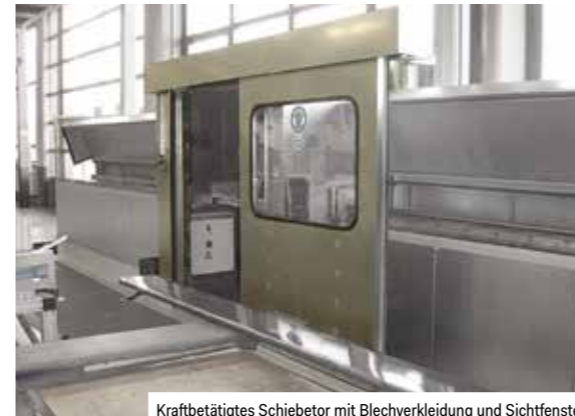
Kraftbetätigtes Schiebetor mit Blechverkleidung und Sichtfenster
