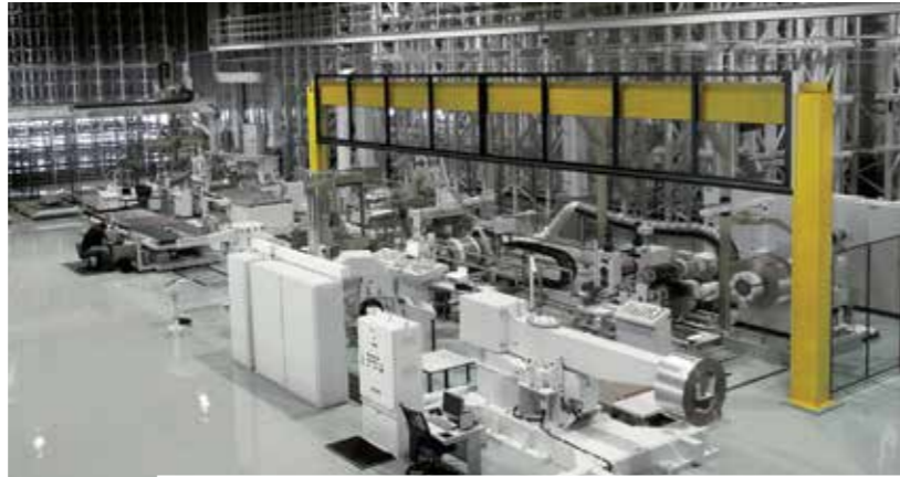
Maschinenschutz-Hubtor XL für flexiblen und schnellen Anlagenzugang und optimale Prozesseinsicht
