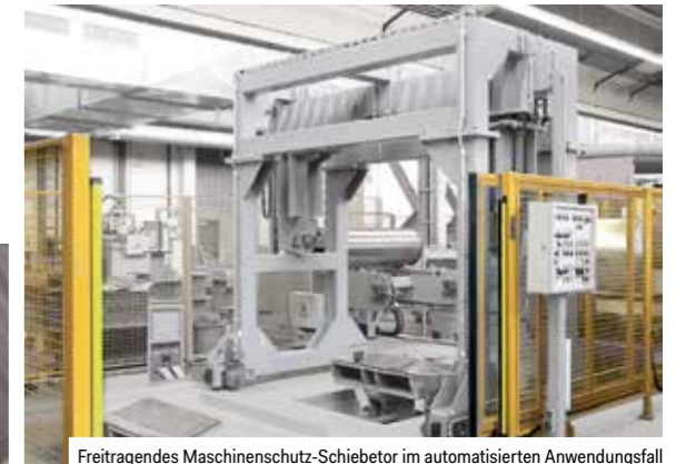
Freitragendes Maschinenschutz-Schiebetor im automatisierten Anwendungsfall
