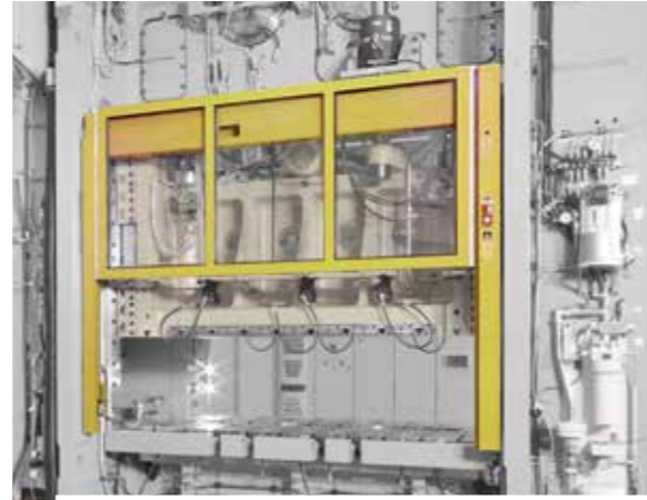
Kompaktes Maschinenschutztor als Prozessintegration mit geringer Einbauhöhe
