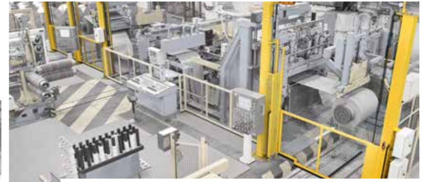
Bandanlage mit mehreren nebeneinander positionierten einseitigen Hubtoren mit versetztem Flügelverlauf
