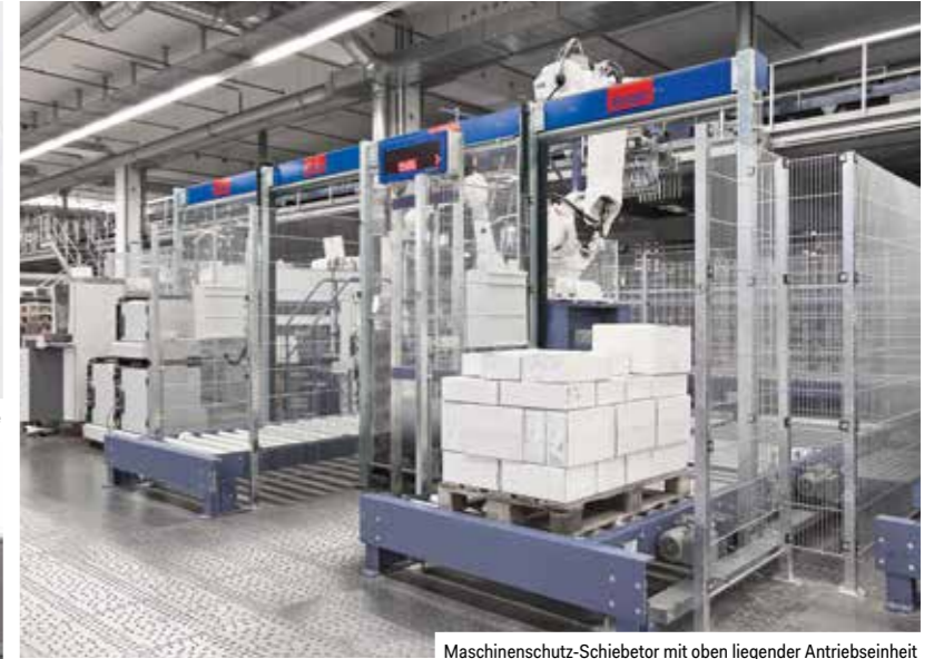
Maschinenschutz-Schiebetor mit oben liegender Antriebseinheit
