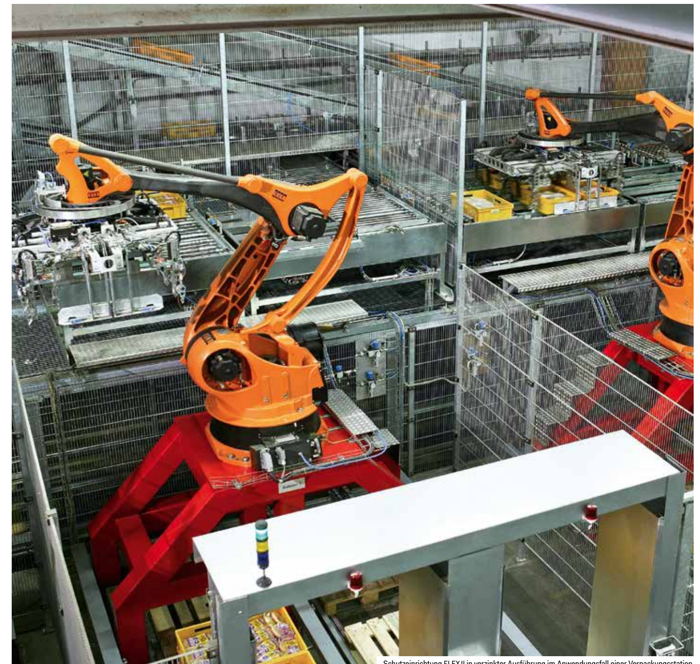
Schutzeinrichtung FLEX II in verzinkter Ausführung im Anwendungsfall einer Verpackungsstation
