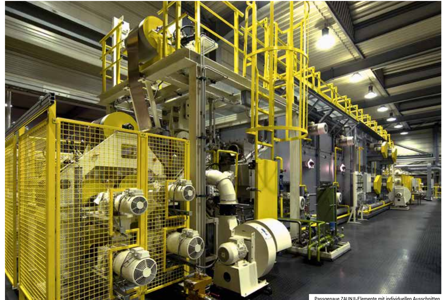
Passgenaue ZAUN II-Elemente mit individuellen Ausschnitten
