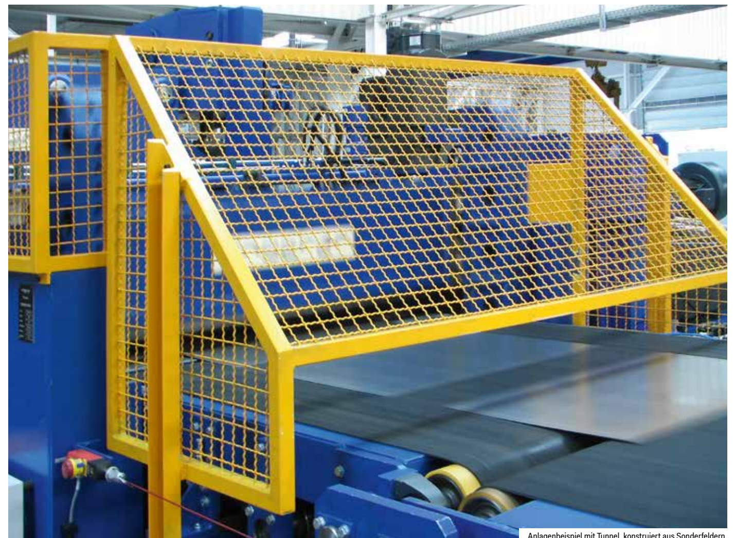
Anlagenbeispiel mit Tunnel, konstruiert aus Sonderfeldern
