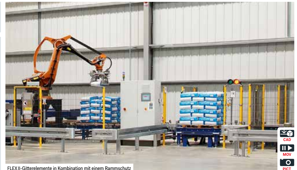
FLEXII-Gitterelemente in Kombination mit einem Rammschutz
