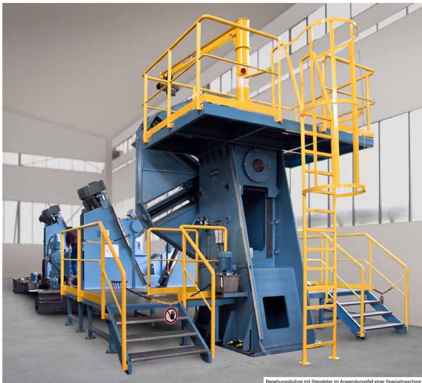
Begehungsbühne mit Steigleiter im Anwendungsfall einer Spezialmaschine
