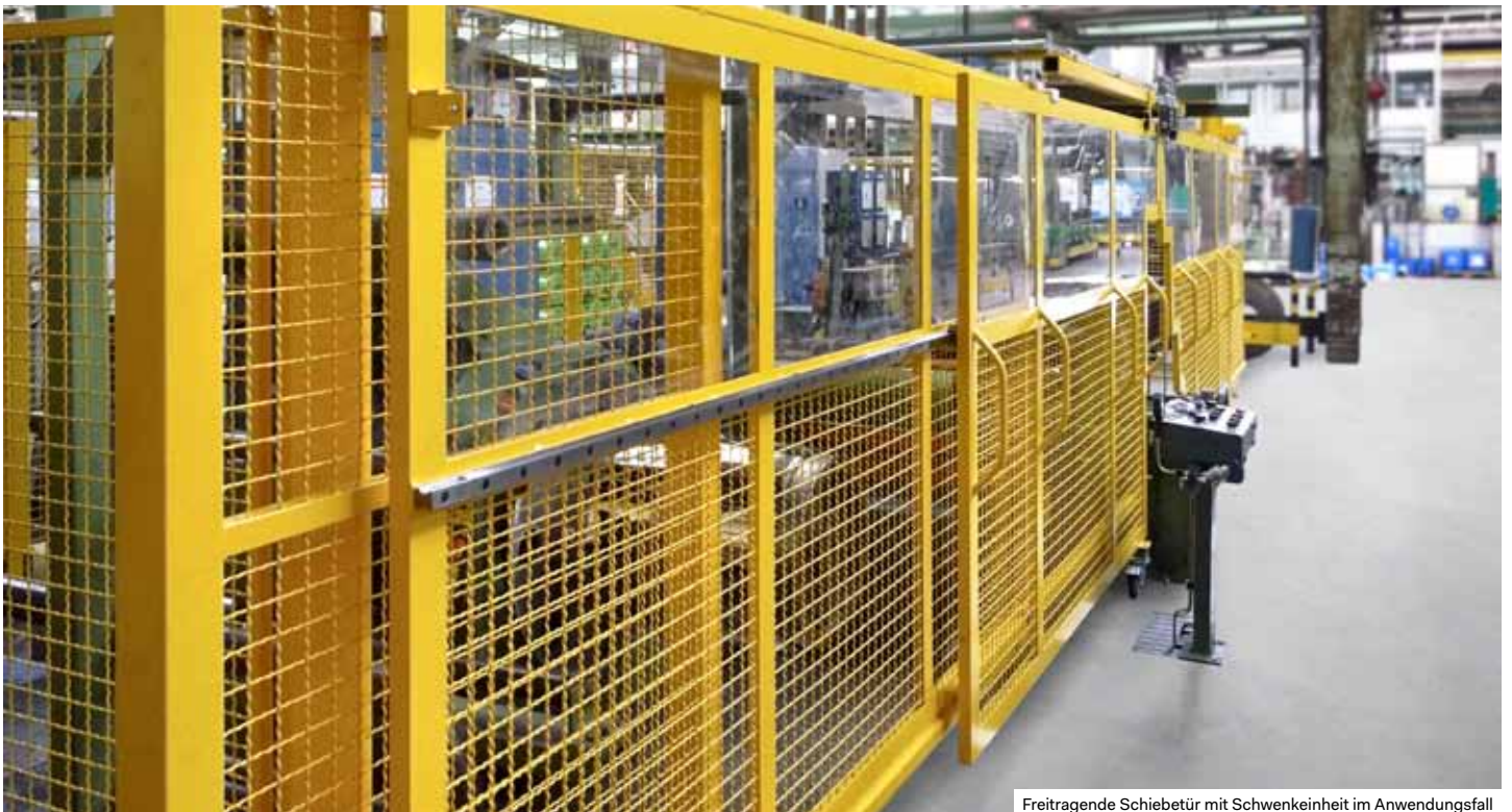
Freitragende Schiebetür mit Schwenkeinheit im Anwendungsfall
