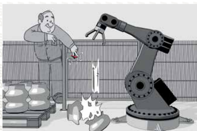
Abb. 7 | So soll es nicht sein: Der Maschinenbediener kann eine innen liegende Fluchtentriegelung von außen betätigen.
