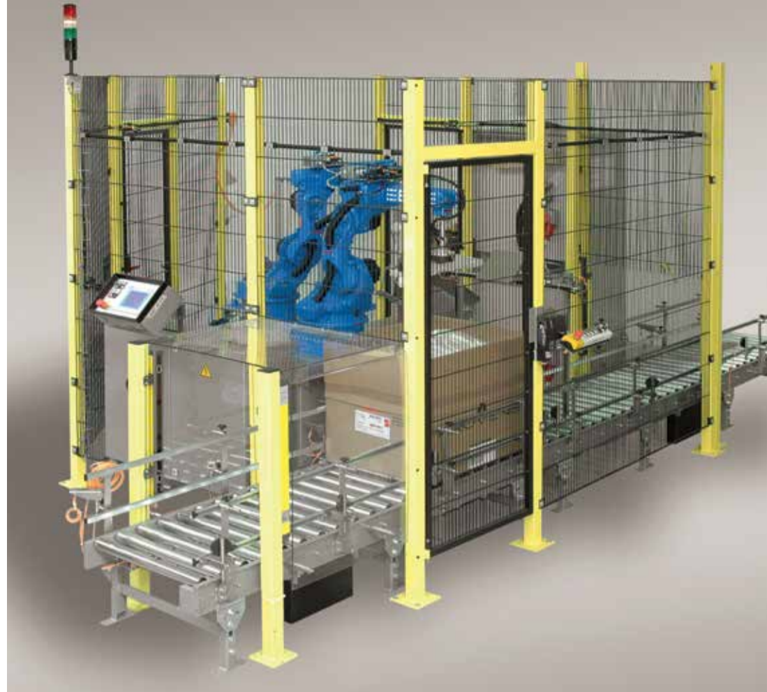
Abb. 1 | Trennende/bewegliche Schutzeinrichtungen im Anwendungsfall einer Roboterzelle.
