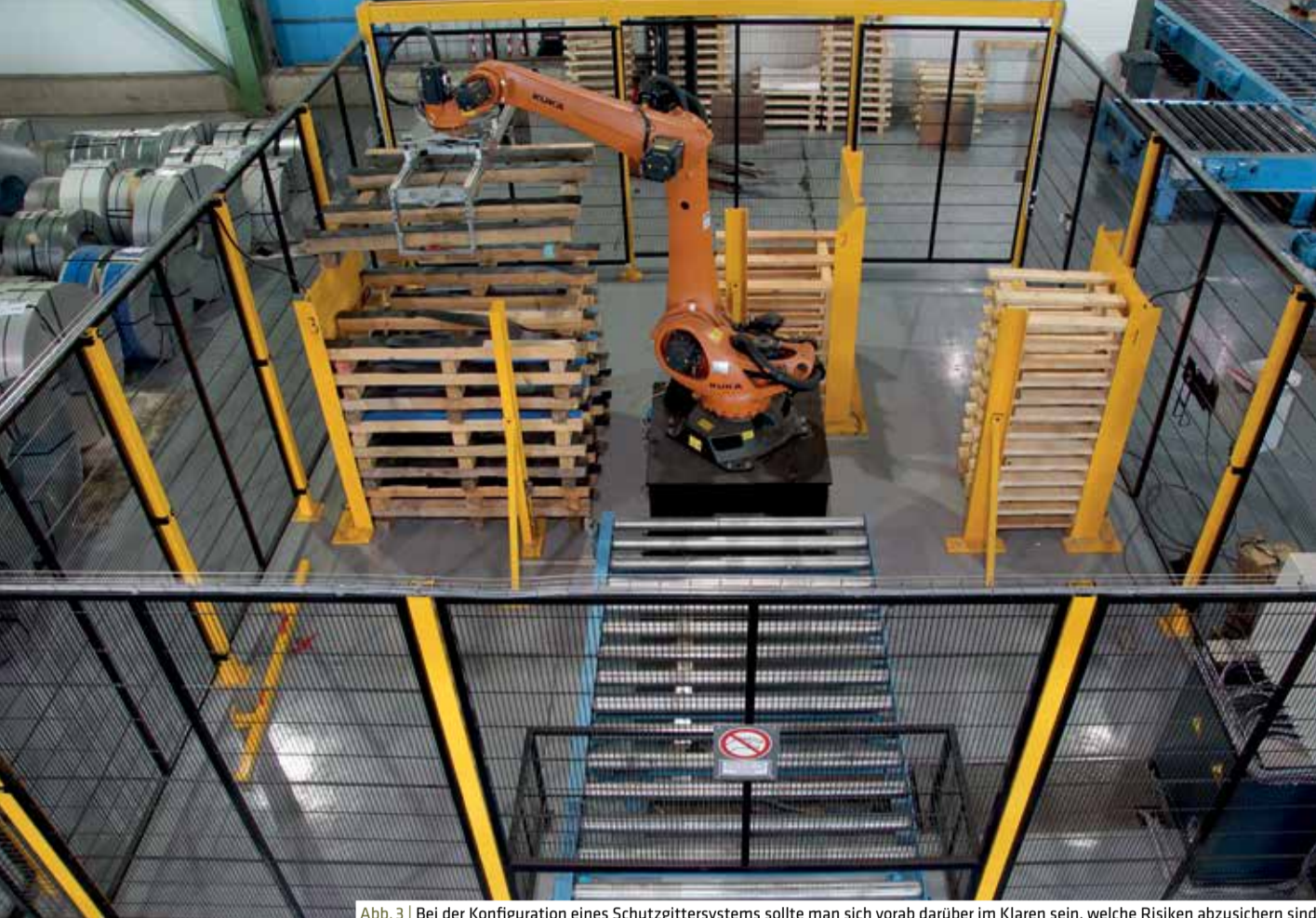
Abb. 3 | Bei der Konfiguration eines Schutzgittersystems sollte man sich vorab darüber im Klaren sein, welche Risiken abzusichern sind.
