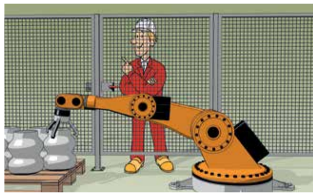
Abb. 8 | So ist es besser: Der hohe Zaun ermöglicht kein Übergreifen, die innen liegende Fluchtentriegelung ist nur innerhalb der Schutzeinrichtung erreichbar.
