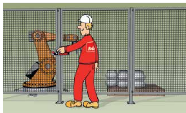
Abb. 9 | So ist es besser: Ein höherer Zaun ermöglicht kein Übergreifen, der Maschinenbediener betätigt nur die auf seiner Zaunseite vorgesehenen Bedienelemente.
